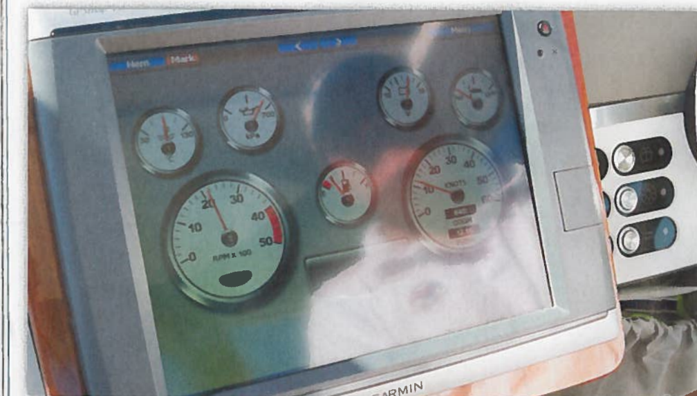
Stor, fast monterad plotterskärm ansluten till båtens NMEA 2000-nätverk visar, förutom sjökort, även allt om motorn.
